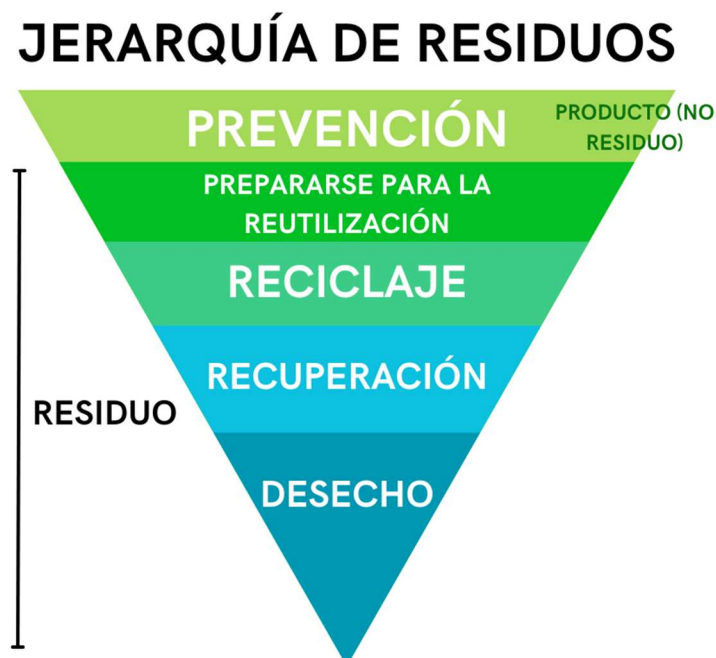
Figura 1 - La guía para la gestión de residuos en la UE es la «jerarquía de residuos» de cinco pasos establecida en la Directiva Marco de Residuos. Establece un orden de preferencia para gestionar y eliminar los residuos.
